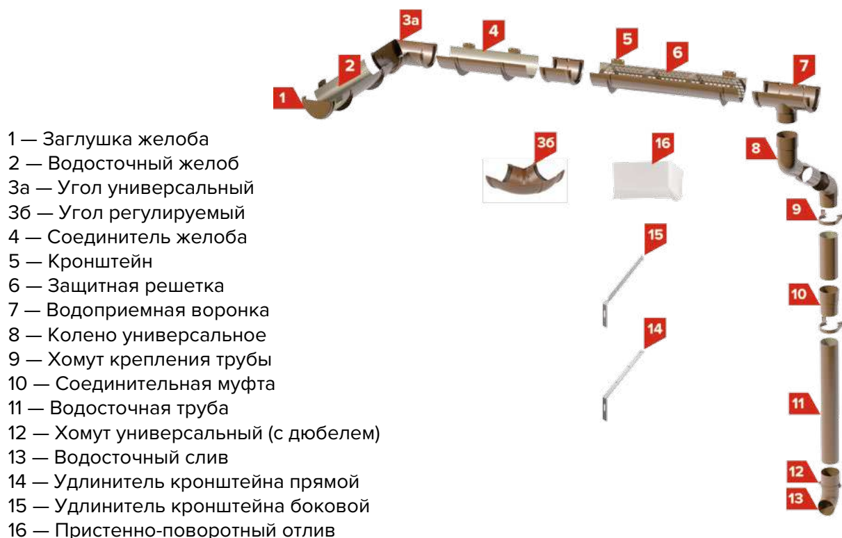
Рисунок Л. 1 — Элементы пластиковой водосточной системы ТЕХНОНИКОЛЬ
